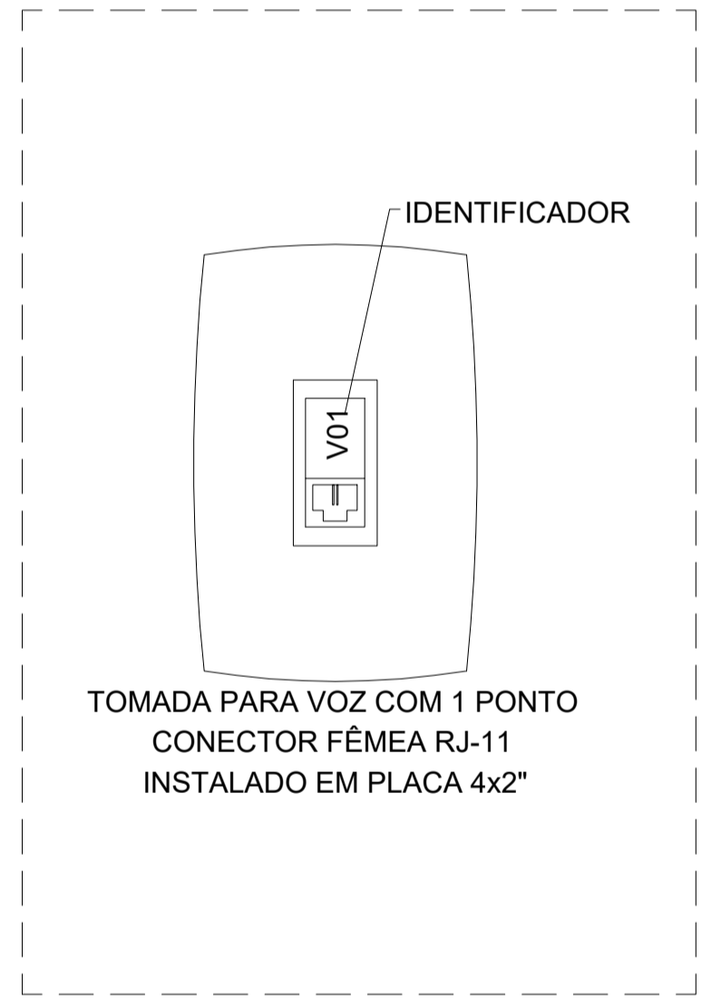
Detalhe 4 - Tomada RJ-11 Sem escala
