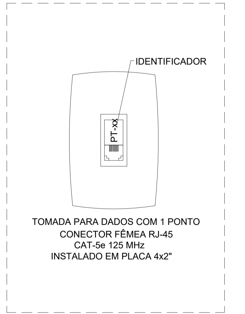
Detalhe 2 - Tomada RJ-45 Sem escala
